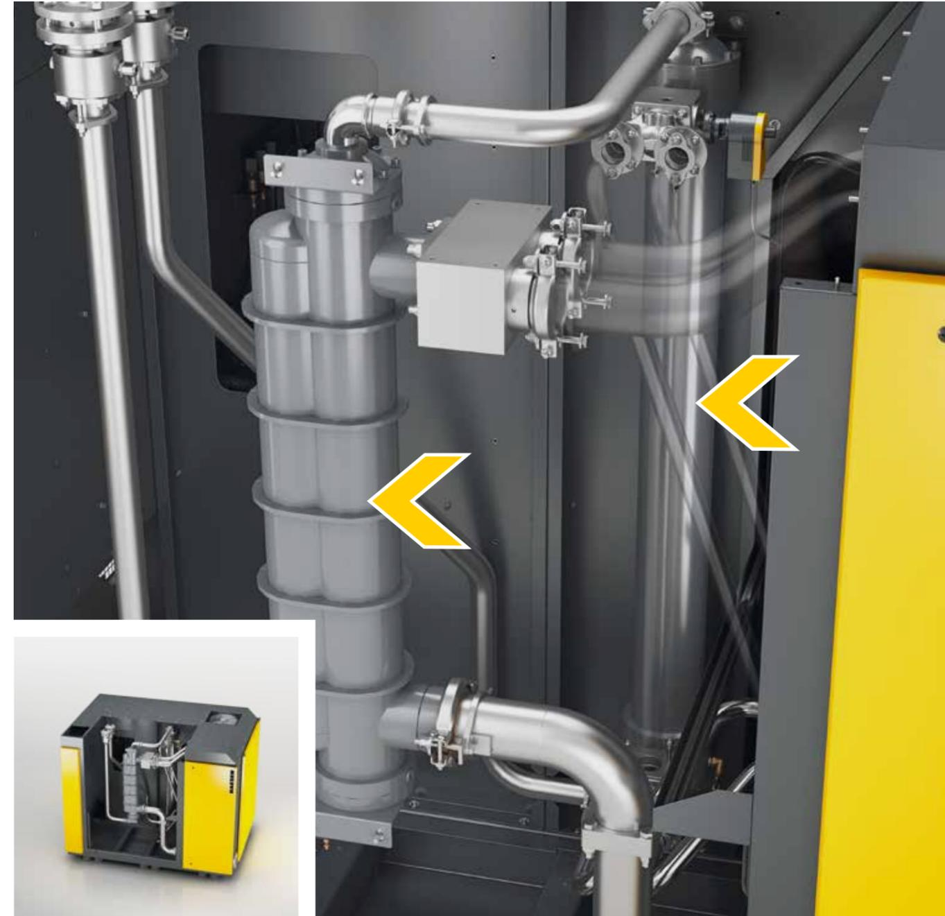
Rohrbündel-Wärmetauscher aus Kupfer-Nickel-Legierung (CuNi10Fe) sind bei Plattenwärmetauschern adäquater Kühlleistung weniger verschmutzungsanfällig, jedoch deutlich robuster und mechanisch reinigbar. Des Weiteren lassen sich die Kühleinsätze sehr einfach wechseln.
