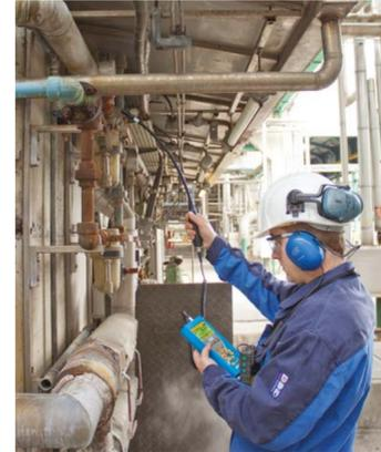
Bevor über Kosteneinsparungen an der Druckluftanlage selbst nachgedacht wird, um den Ertrag zu steigern und die Energiekosten zu reduzieren, sollte an erster Stelle daran gedacht werden, diese große Verschwendung durch Leckagen zu beseitigen. Mit dem SDT270 und seinen zahlreichen Sensoren und umfassendem Zubehör können Sie sehr leicht Ihre Leckagen lokalisieren und so den Verlust auf ein angemessenes Volumen von 5 % des verbrauchten Volumens reduzieren.
